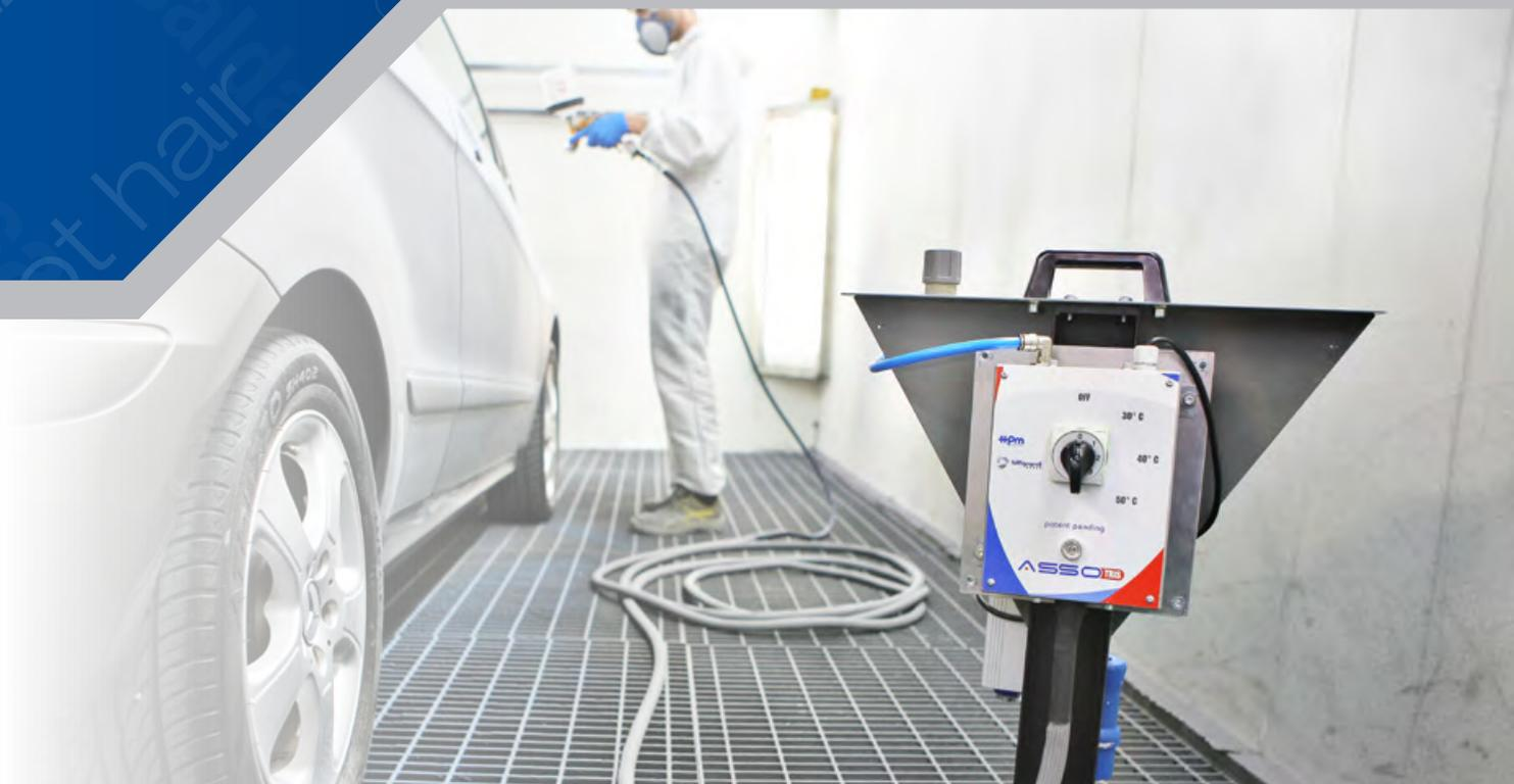
**ASSO** è un sistema brevettato, progettato per riscaldare l'aria compressa che alimenta la pistola o i vari equipaggiamenti utilizzati durante i processi di verniciatura o durante le applicazioni di altri fluidi che richiedono l'utilizzo di pistole ad aria compressa.
